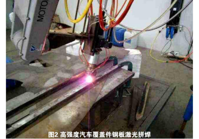
图2 高强度汽车覆盖件钢板激光拼焊
